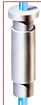
Über Permanentmagnete wird ein Magnetfeld erzeugt, an dem das Befeuchterwasser vorbeigeleitet wird. So wird der Verdunstungsfilter permanent mit sauberem, entkalktem und keimreduziertem Wasser versorgt.
