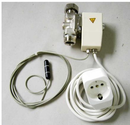
Der Sensor des Wasserwächters liegt in der Sicherheitsauffangwanne und stoppt bei Wasserkontakt die Wasserzufuhr zum Luftbefeuchter. Zusätzlich ertönt ein Signalton, der erst durch Unterbrechung der Stromzufuhr deaktiviert wird.
