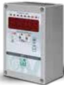
Die kabelgebundene Steuereinheit VORT T mit LCD-Display kann bis zu 20 Geräte verwalten und ermöglicht die automatische Steuerung der Geschwindigkeit der angeschlossenen Ventilatoren anhand der Messwerte des Temperatursensors und eines optionalen Anemometers. Die Geschwindigkeit der Ventilatoren wird entsprechend der Raumtemperatur oder alternativ anhand der Windgeschwindigkeit erhöht oder verringert (nützlich für Geräte, die in Ställen mit großen Außenöffnungen installiert sind).
